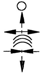
Включение и выключение блокировки рессор
