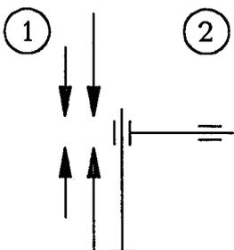
Выдвижение — втягивание первой и второй выносных опор и направление движения рычагов управления
