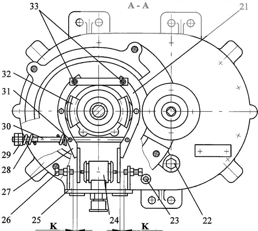
Рисунок 20 – Механизм поворота
