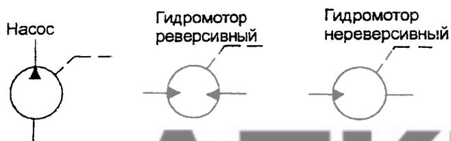
Рис. 21. Насос-гидромотор:
