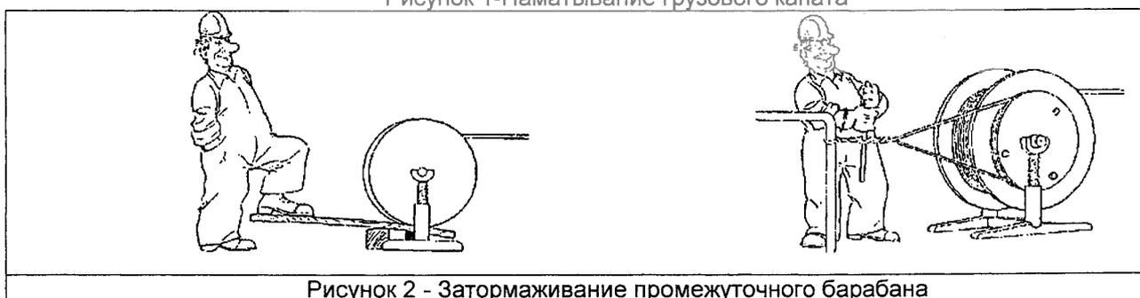
Рисунок 2 - Затормаживание промежуточного барабана
