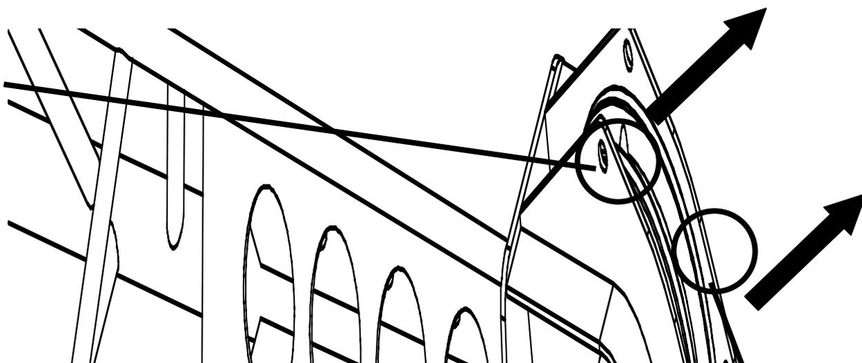
Рисунок 13.27 – Удаление осей с фиксаторами на оголовке гуська
