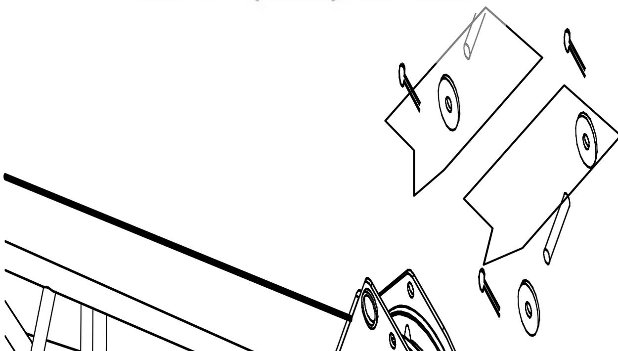
**Рисунок 13.26 – Установка осей с фиксаторами на оголовке гуська**
