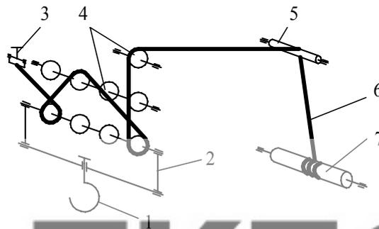
Схема однократной запасовки грузового каната
