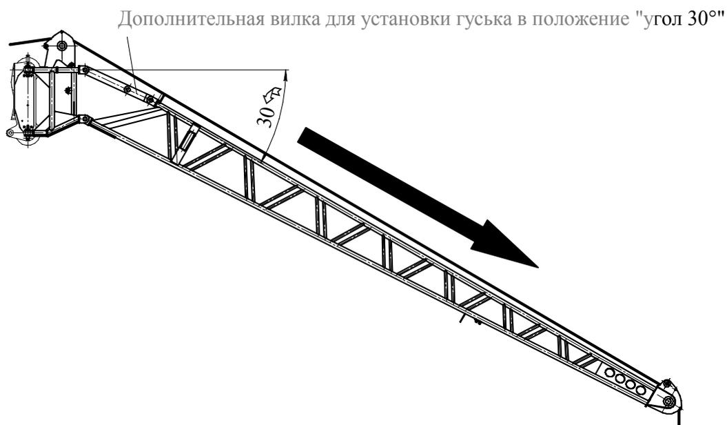
**Рисунок 13.23 – Перевод гуська в положение «угол 30°»**
