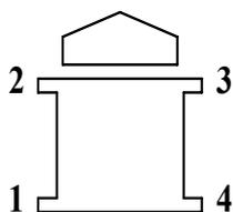
Схема расположения выносных опор на кране
