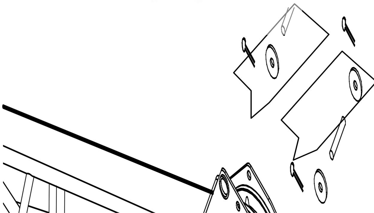
**Рисунок 13.32 – Установка осей с фиксаторами на оголовке гуська**
