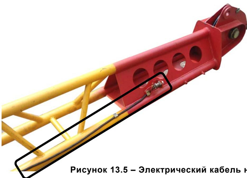
**Рисунок 13.5 – Электрический кабель на гуське**
