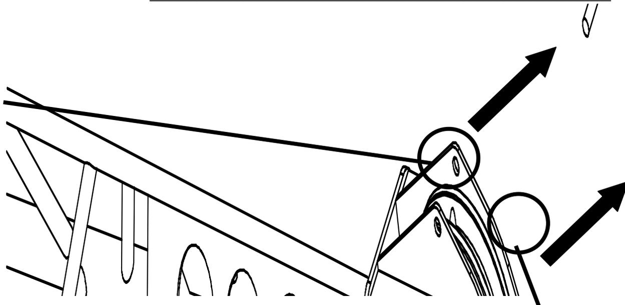
Рисунок 13.33 – Удаление осей с фиксаторами на оголовке гуська
