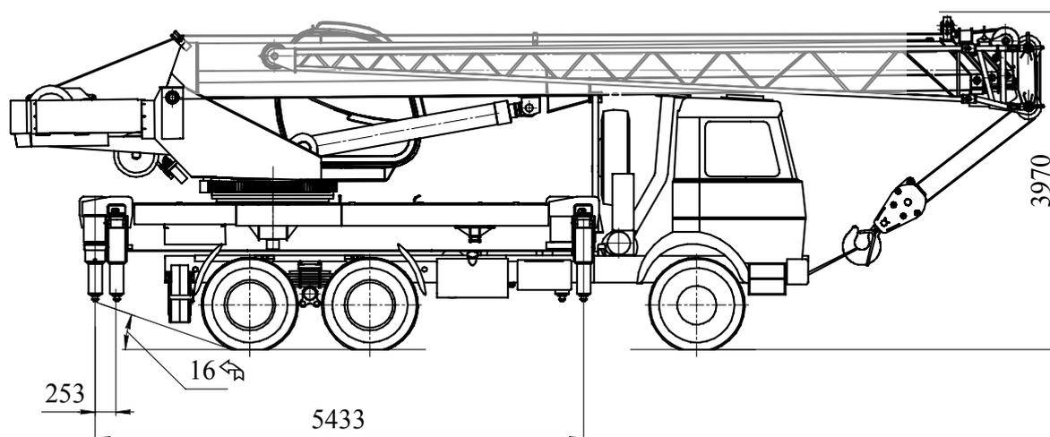
Рисунок 1.2 – Общий вид крана в транспортном положении с гуськом
