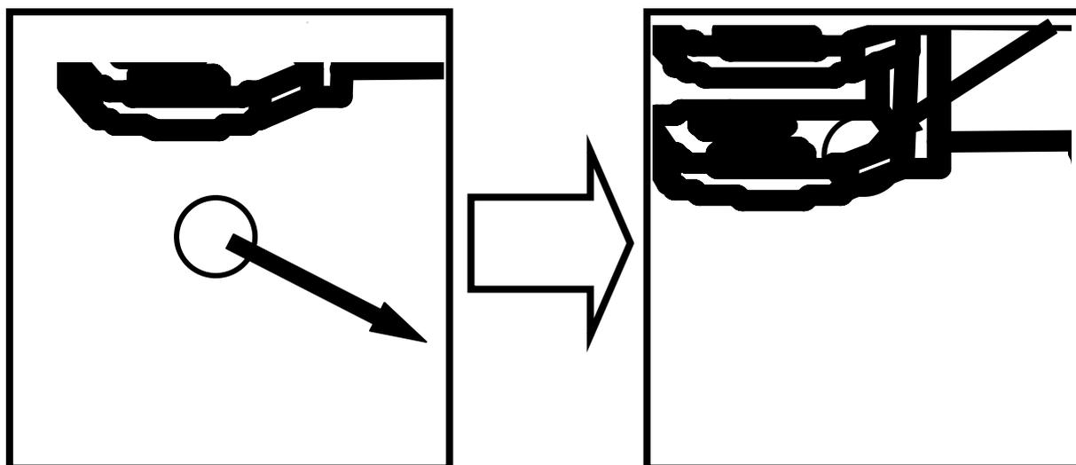
Рисунок 13.1 – Перевод блока основания гуська в рабочее положение
