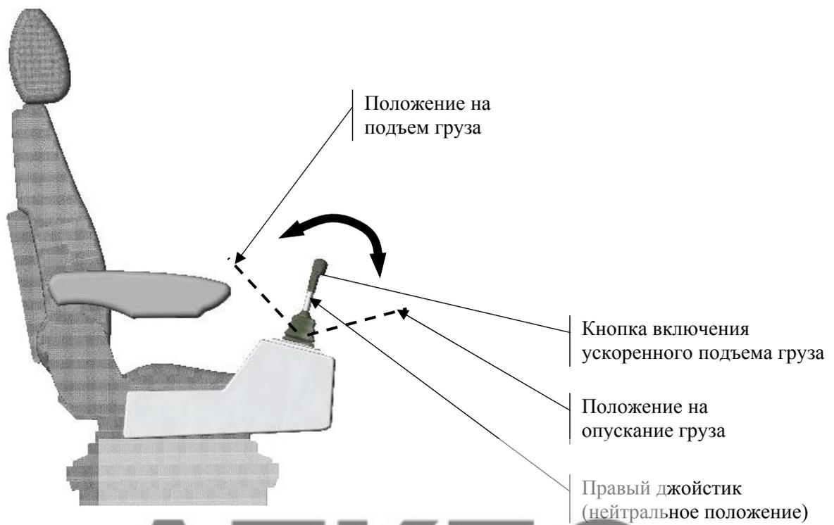
Рисунок 14.1 – Управление подъемом и опусканием груза
