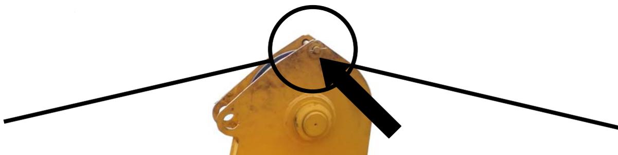
**Рисунок 13.15 – Установка оси на блоке основания гуська**
