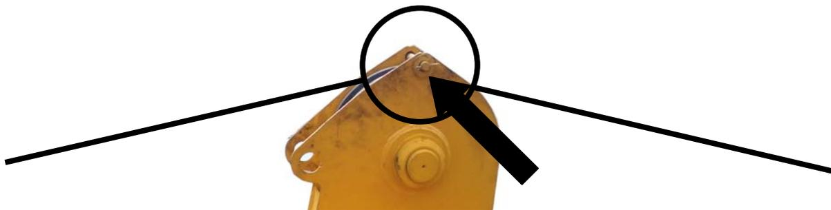
**Рисунок 13.3 – Установка оси на блоке основания гуська**
