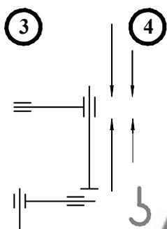
Выдвижение (втягивание) третьей и четвертой гидроопор и направление движения рычагов управления
