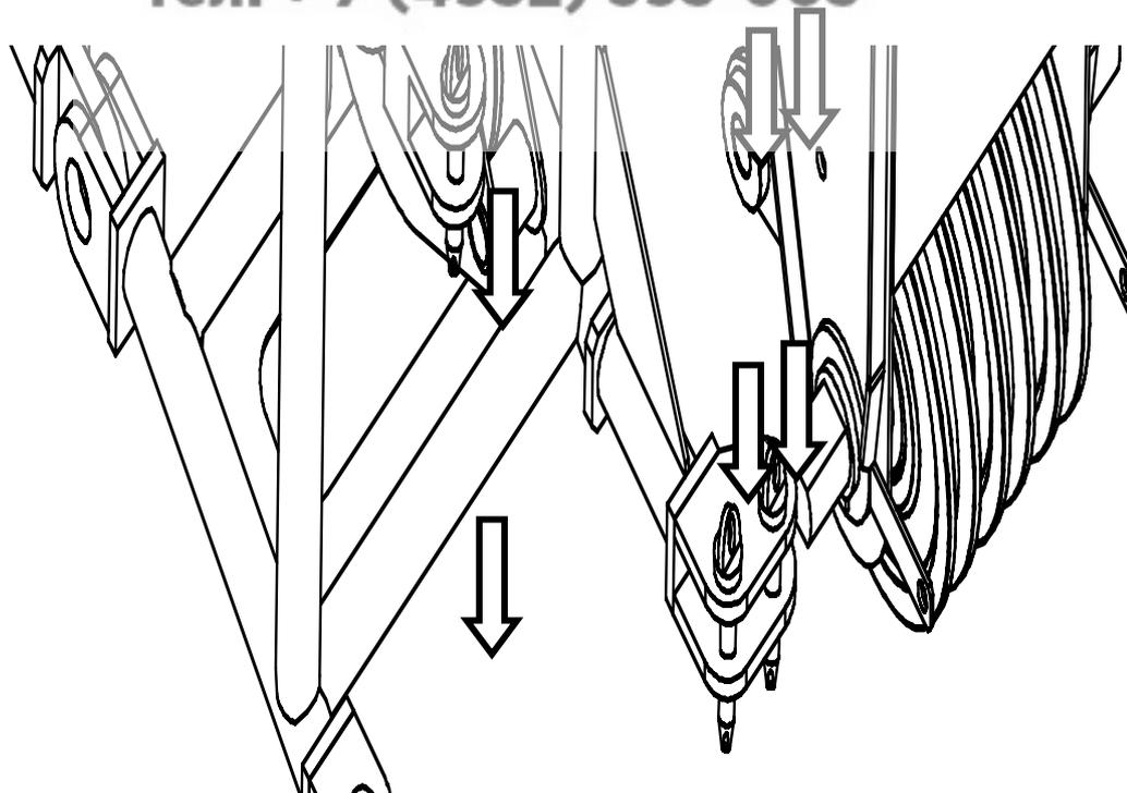
Рисунок 13.43 – Установка пальцев в вилки основания гуська
