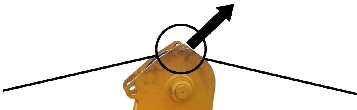
**Рисунок 13.46 – Удаление оси на блоке основания гуська**
