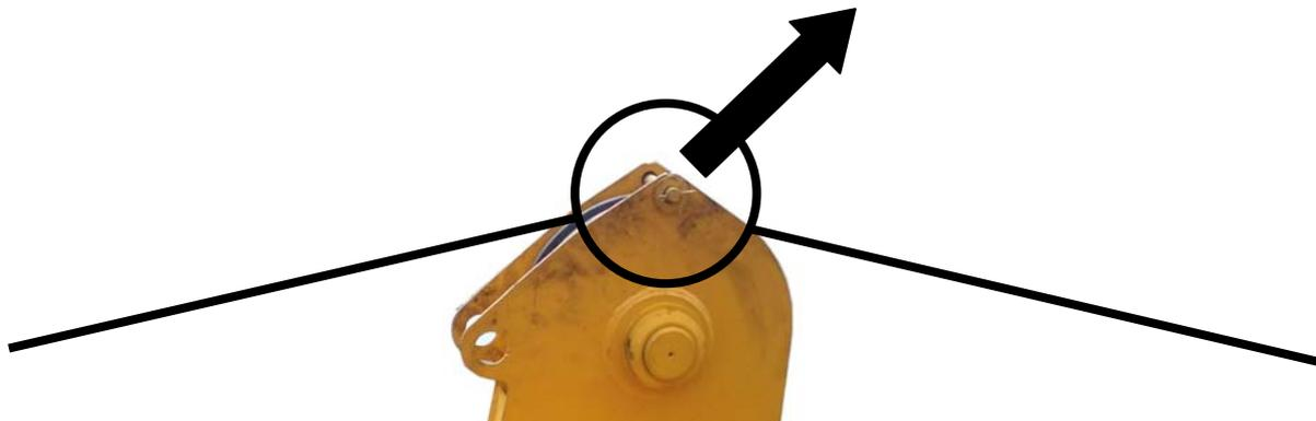
Рисунок 13.20 – Удаление оси на блоке основания гуська
