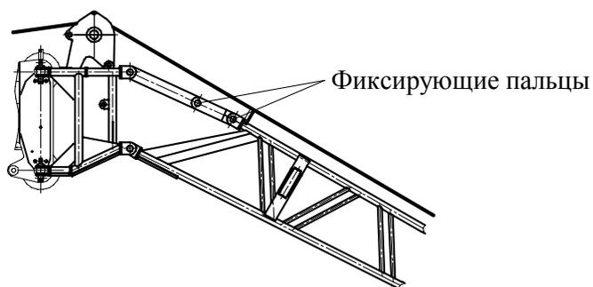
**Рисунок 13.24 – Фиксация вилки
