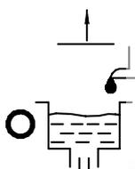
Заливка жидкости в емкость
